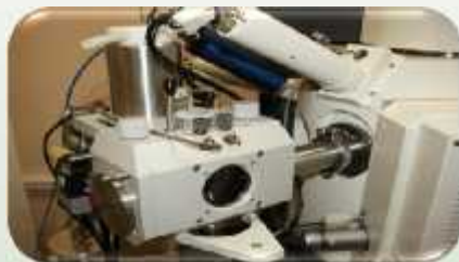
Электронный сканирующий микроскоп Supra 55 VP, Carl Zeiss с криоприставкой
