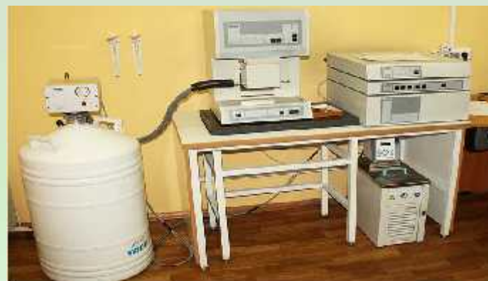
Прибор для динамического механического анализа DMA 242C, NETZSCH
