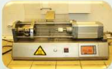
Микроэкструдер с приставкой для получения пленок и волокон DSM 5 Xplore
