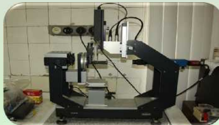
Прибор для измерения краевого угла смачивания DSA30, Kruss
