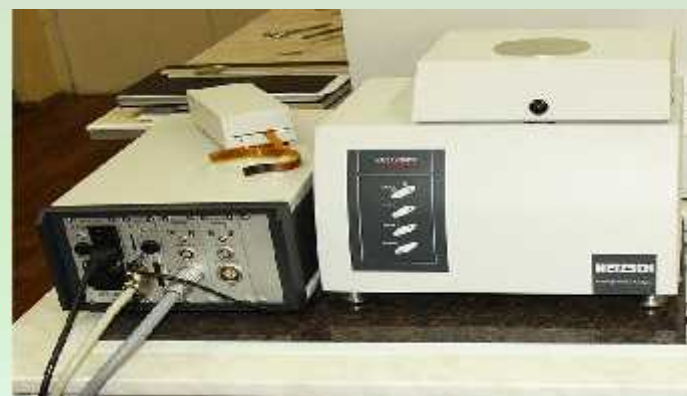
Диэлектрический анализатор DEA 288, NETZSCH
