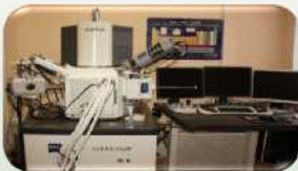
Электронный сканирующий микроскоп Supra 55 VP, Carl Zeiss с криоприставкой
