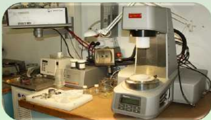
Реометр MCR301 Anton Paar
