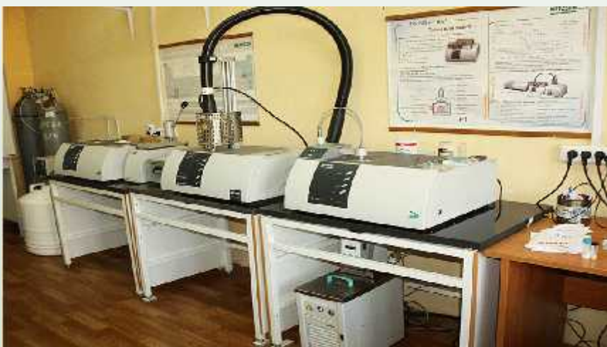
ТГА TG 209F1 сопряженный с квадрупольным масспектрометром QMG 403C, NETZSCH
